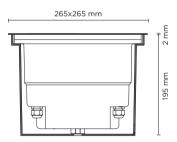
HOLE FOR RECESSING 257x257 mm
